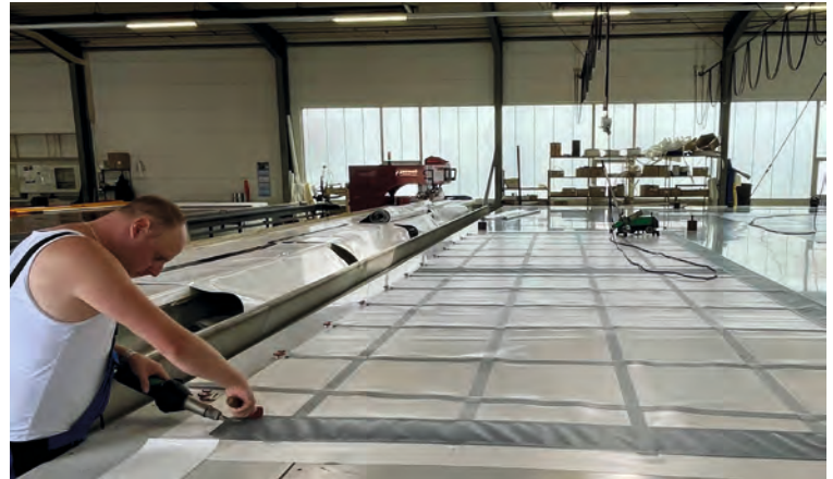
Einer der Arbeitsschritte in der LKW-Planen-Herstellung ist das Aufschießen der Verstärkungen.
